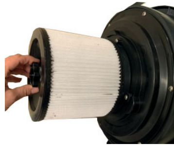
Abb. 21: Ersetzen der Filterpatrone
