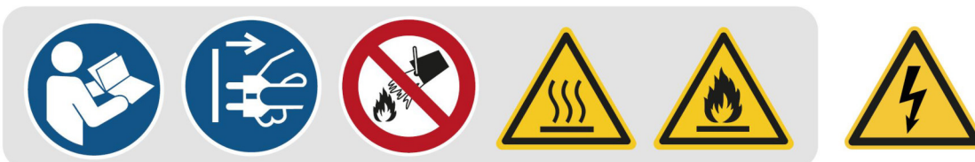
Abb. 1-1: Sicherheitskennzeichnungen (v.links Gebrauchsanweisung beachten!, Netzstecker ziehen!, Mit Wasser löschen verboten!, Warnung vor heißer Oberfläche!, Keine offene Flamme!, Warnung vor elektrischer Spannung!)
