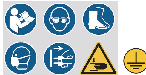
Abb. 1: Sicherheitskennzeichnungen an der Sandstrahlkabine SSK 1 1 Gebotszeichen: Anleitung beachten, Augenschutz benutzen, Fußschutz benutzen, Maske benutzen, Netzstecker ziehen | 2 Warnzeichen: Warnung vor Handverletzungen, Vor Benutzung erden
