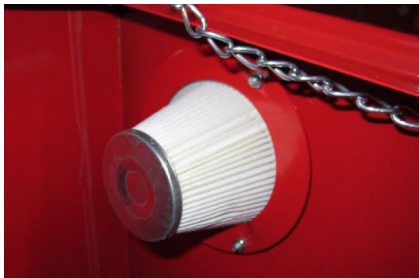
Abb. 12: Filter der Sandstrahlkabine
