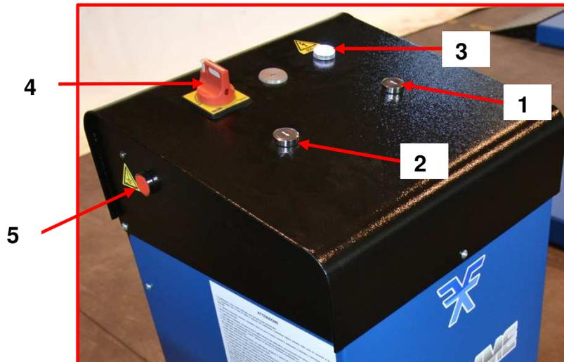
1. **Aufwärtstaste:** Durch Drücken darauf werden der Motor und die Mechanismen, die den Aufstieg des Hubtischs auslösen, aktiviert.
