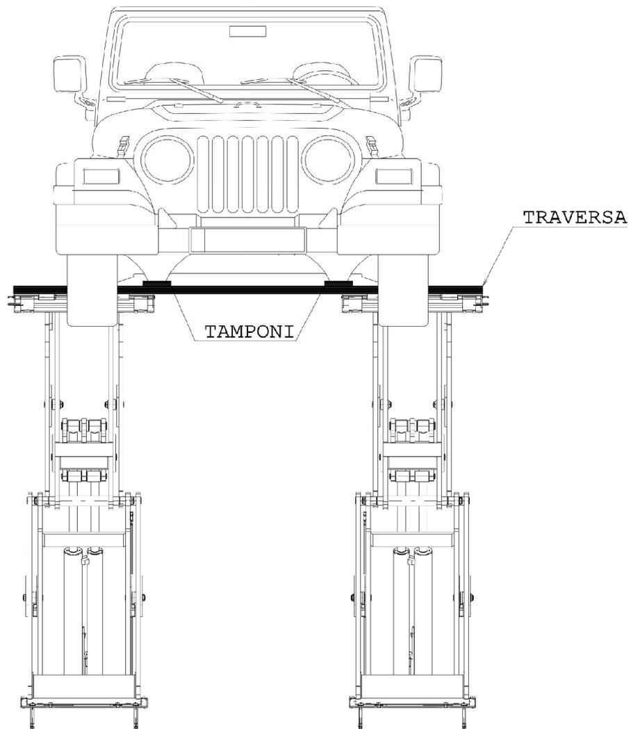
Bei Geländewagen, Transporter oder andere Fahrzeuge mit sehr enge oder sehr breite aufnahmepunkte, ist es gezwungen eine Aufnahmestrebe mit Aufnahmeblöcke zu verwenden.
